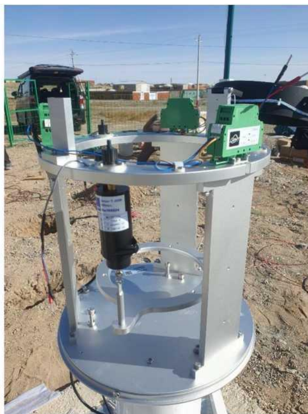
Зураг: Автомат станцын мэдрүүрүүдийг угсарсан байдал
