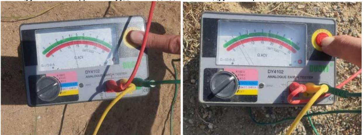
Зураг: Алтай, Тонхил өртөөдийн автомат станцын газардуулгын эсэргүүцэл хэмжсэн байдал
