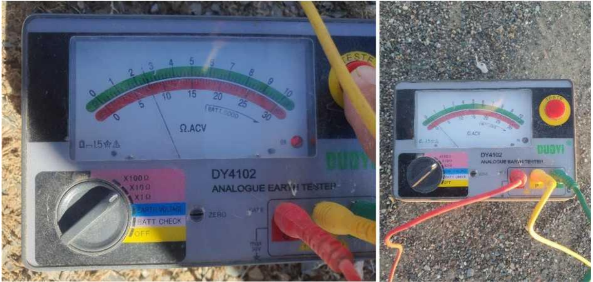
Зураг: Бугат, Хөхморьт өртөөдийн автомат станцын газардуулгын эсэргүүцэл хэмжсэн байдал
