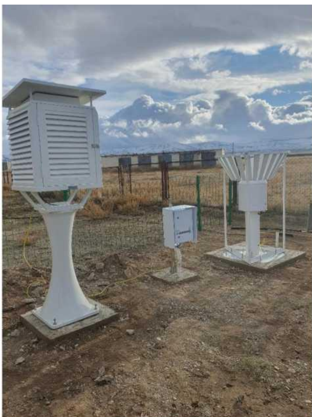
Зураг: Автомат станцын мэдрүүрүүдийг угсарсан байдал
