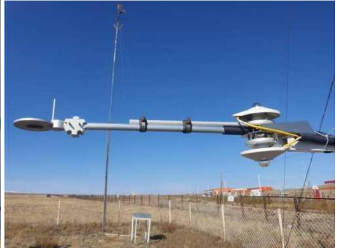
Зураг: Пиранометруудийг талбайд байрлуулж угсарч суурилуулсан байдал
