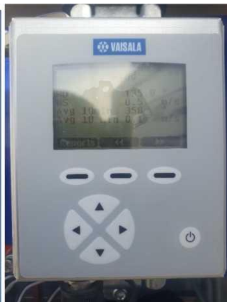
Зураг: салхины мэдрүүрийн холболт хийж шалгаж байгаа байдал
