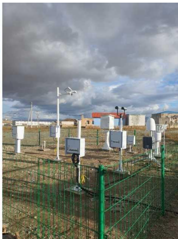
Зураг: Автомат станцын мэдрүүрүүдийг угсарсан байдал
